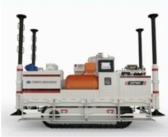
图 2 ZDY6000LD (B) 型定向钻机
